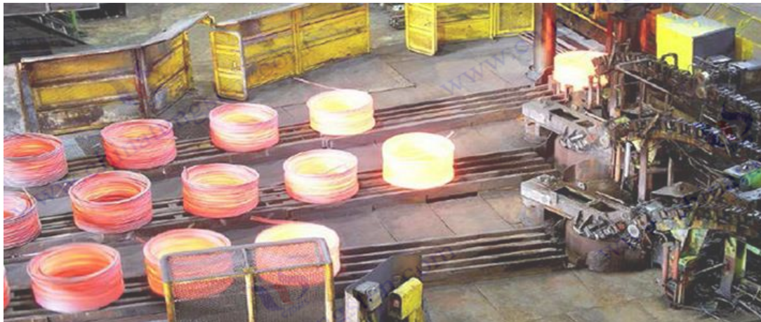
金刚线基体母丝碳钢线盘条生产
